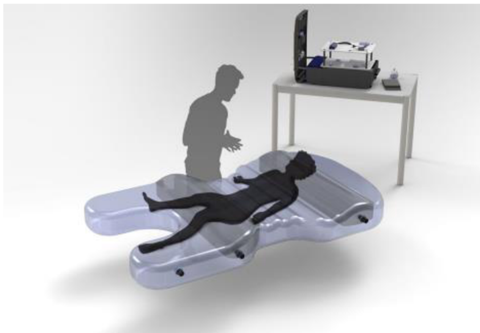
Obr. 1 Schéma matrace s nezávislými vzduchovými komorami pro přizpůsobení a změnu držení těla klienta. Zdroj: Morales (2020).
