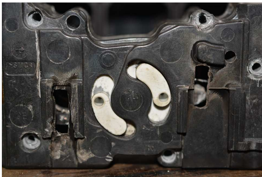
Obr. 4.2 Úprava pólové kazety pro umožnění měření
