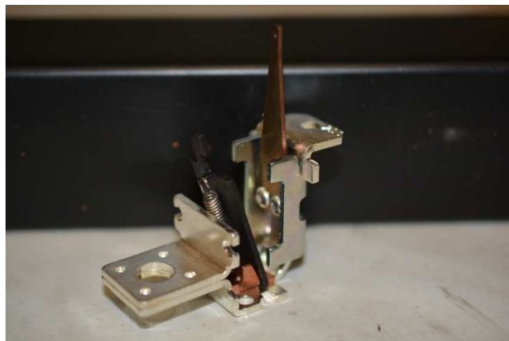
Obr. 2.2 Tepelná a elektromagnetická spoušť výkonového jističe
