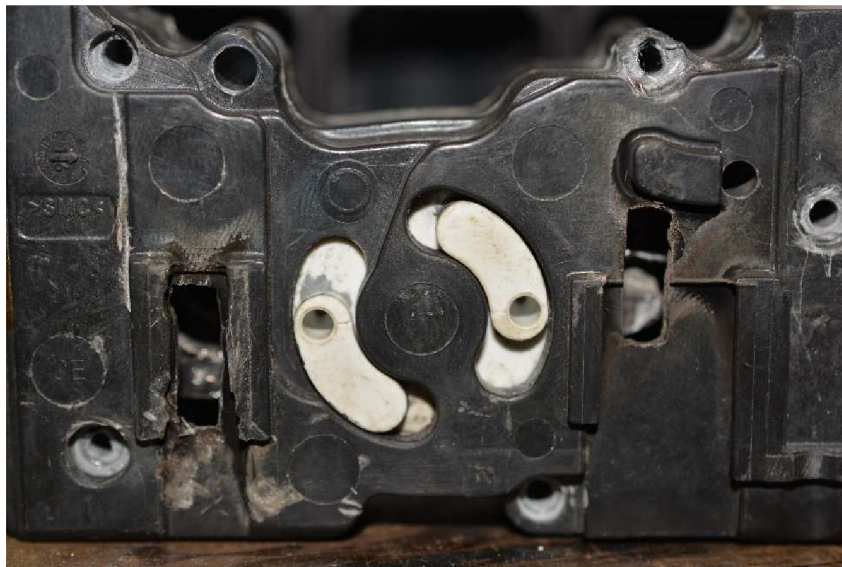
Obr. 4.2 Úprava pólové kazety pro umožnění měření
