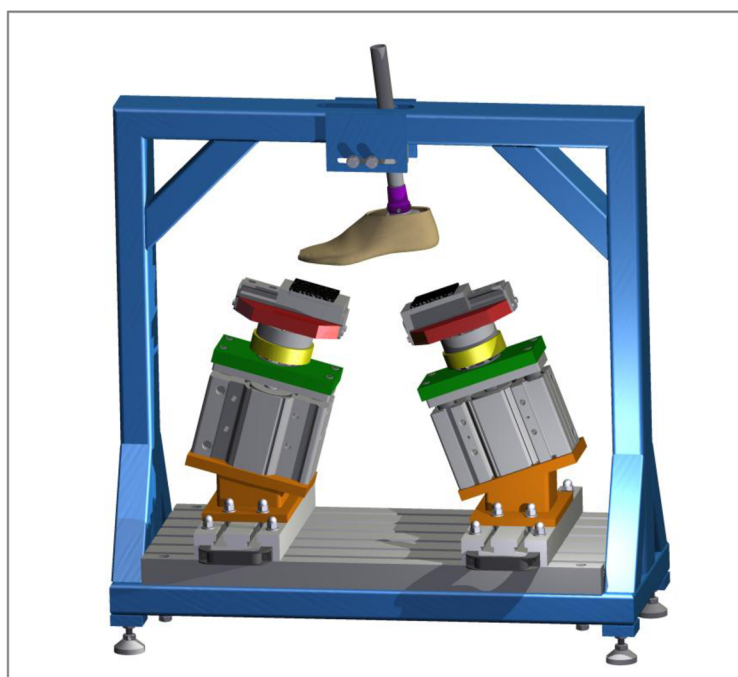
Obr. 4-4 Finálny konštrukčný návrh
