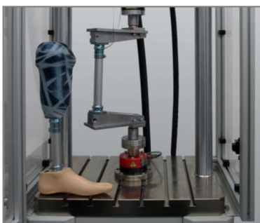
Obr. 2-11 Zariadenie pre životnostné a statické skúšky spojovacieho adaptéru Zwick Roel [15]
