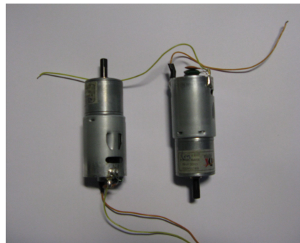
Obrázek 3.1: Motory pro vlastní podvozek DS MOTOR WIK25GAD027.
