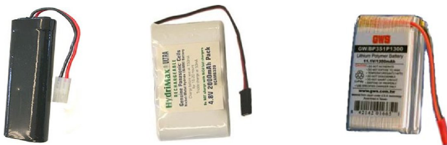
Obrázek 2.21: Ukázka různých typů baterií: a) NiCd (vlevo) b) NiMH (uprostřed) c) Lithiová (vpravo) [16].
