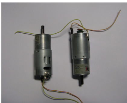
Obrázek 3.1: Motory pro vlastní podvozek DS MOTOR WIK25GAD027.
