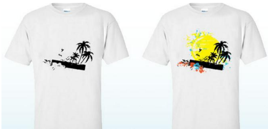
Obrázek 11: Tričko s fotochromní úpravou před působením UV záření a po působení UV záření [39]
