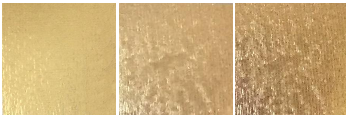
Obrázek 18: Vzorky textilie s metalickou fólií s různou teplotou fixace; 120°C, 160°C, 200°C
