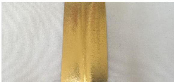
Obrázek 21: Hřbetový šev přeplátovaný metalickou fólií
