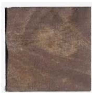
Obrázek 23: Vzorek textilie s před úpravou koncentrovanější kyseliny chrom sírové
