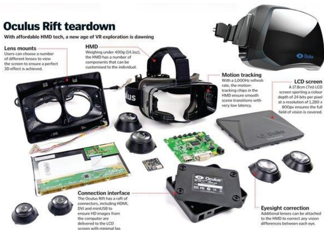
Obrázek 5: Ilustrační schéma komponentů HMD Oculus Rift s vysvětlivkami
