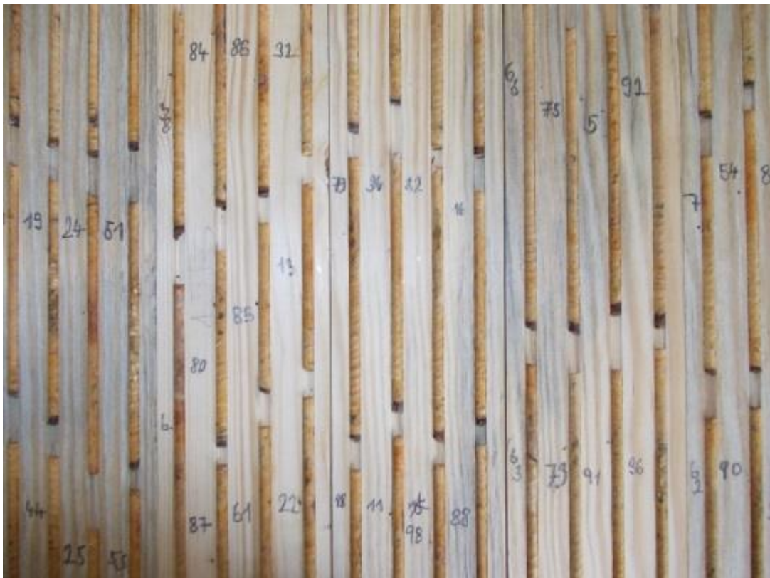
Foto č. 13 : Vývrty nalepené na podložce.
