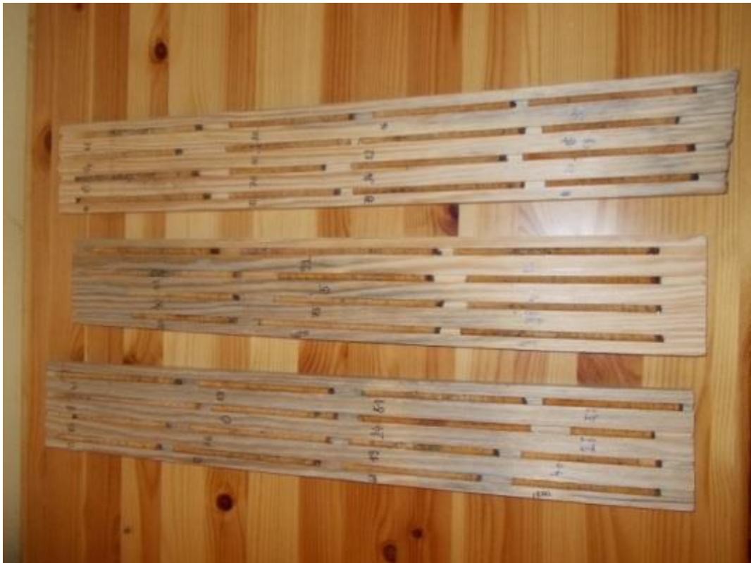
Foto č. 13 : Vývrty nalepené na podložce.
