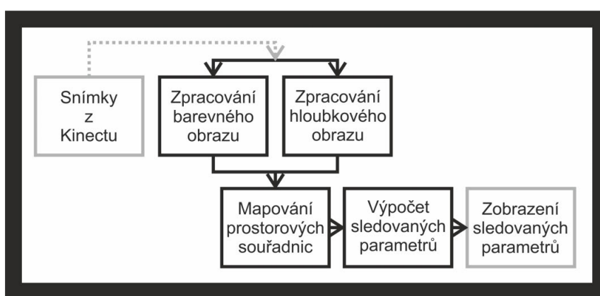
Obr. 4.1: Vývojový diagram postupu zpracování obrazu
