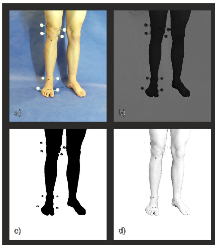
Obr. 4.2: a) Výchozí snímek b) Složka barevného tónu (H) modelu HSV výchozího snímku c) Maska vytvořená prahováním složky H d) Snímek s odstraněným pozadím
