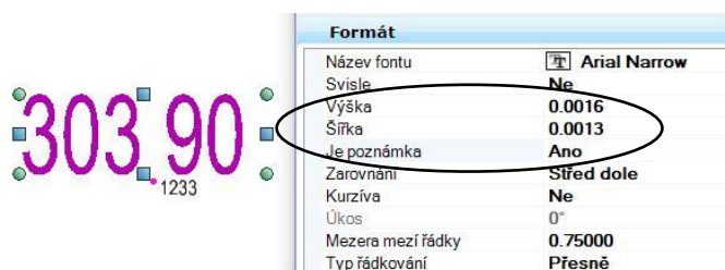
Obr. 77 Text výškových kót využívající anotaci
