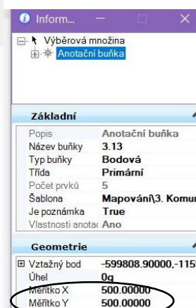
Obr. 66 Přepočítání anotačního měřítka vložené buňky
