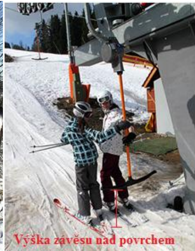
Obrázek 4. Bubínkový vlek dvojmístný ( http://mountainski.cz/182/vikend-v-pulce-brezna-na-lyzich-v-okrese-vsetin-trojka-a-kycerka )
