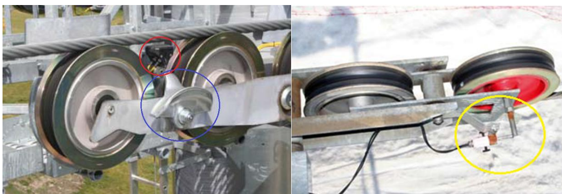
Obrázek 13. Červený kruh-systém RPD, modrý kruh-zachycovač lana, žlutý kruh-systém RLS (Gric, 2009).
