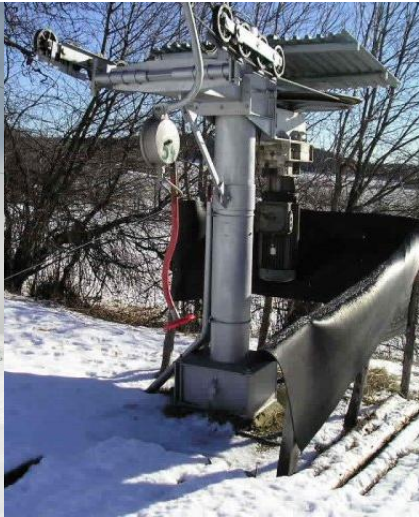
Obrázek 3. Bubínkový vlek jednomístný ( http://www.polarplus.cz/secondhand/7-blv-0.html ).
