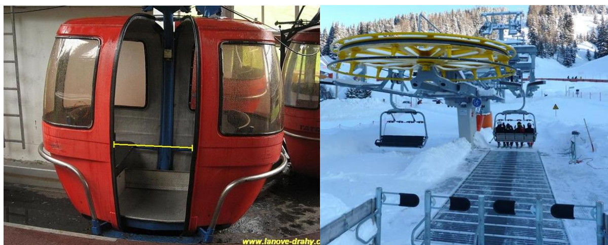
Obrázek 11. Měření šířky dveří u kabinkové lanovky. Obrázek 12. Rozběhový pás s intervalovými závoryami ( http://www.lanove-drahy.cz/ ).
