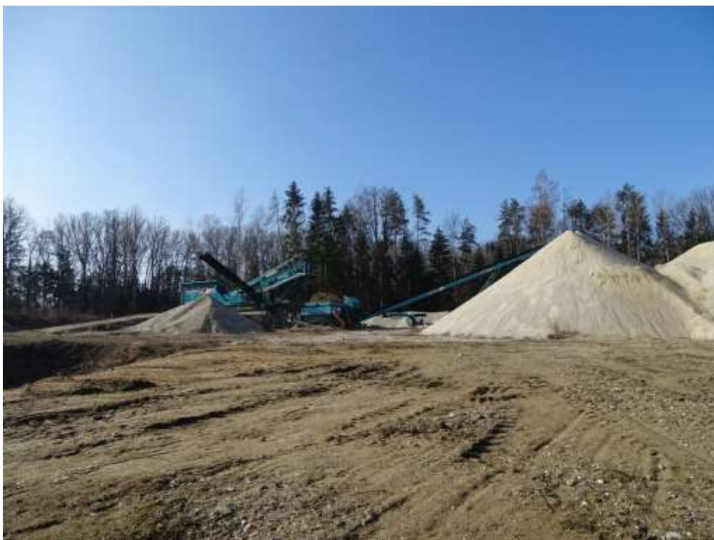
Fotografie č. 3 Třídící linka a zásoby vytříděné suroviny v DP Horusice
