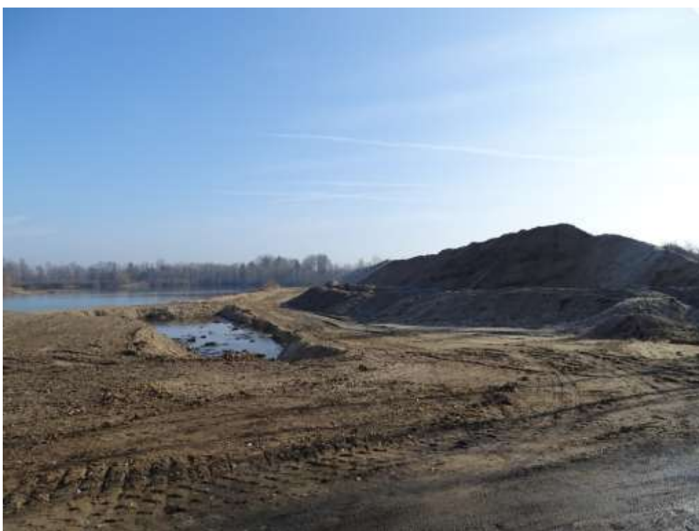
Fotografie č. 4 Natěžená surovina na dočasně odvodňovací deponii v DP Horusice před jejím odvozem k třídící lince
