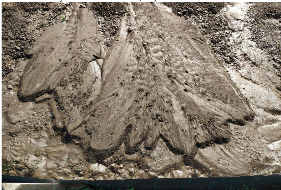
Obr. 16: Ukázka zachyceného sedimentu (zdroj: David Kincl)
