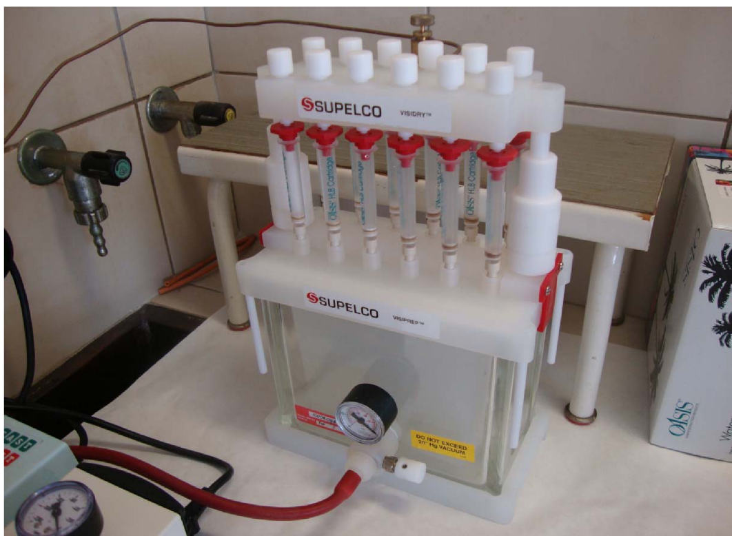
Obr. 54: Proces sušení SPE kolonek dusíkem s využitím speciálního nástavce
