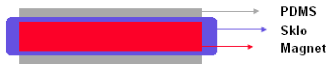
Obr. 17: Schéma zařízení pro SBSE (62)
