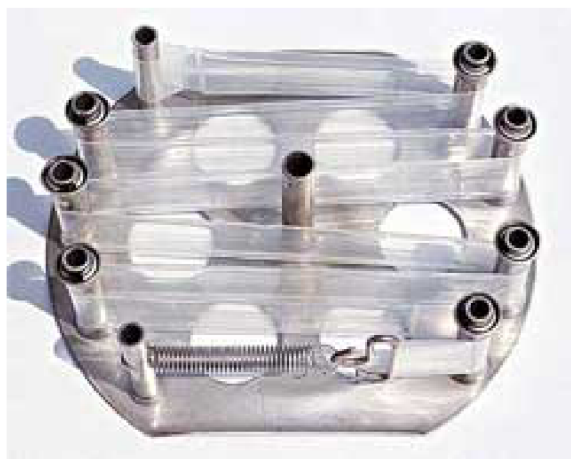
Obr. 26: Patro vzorkovače SPMD s napnutou membránou (84)
