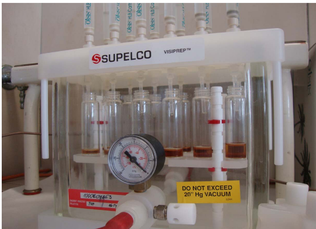
Obr. 55: Eluce analytů ze sorbentu SPE kolonek
