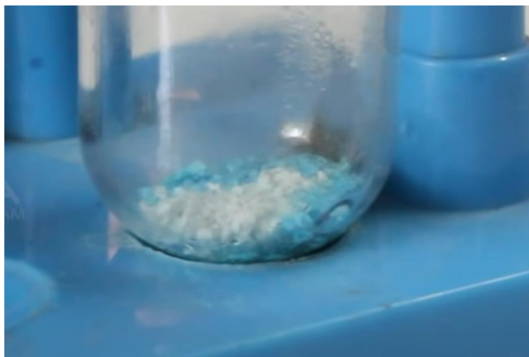
Obrázek 20: Krystalky bezvodé modré skalice (bílé krystalky) a hydratované (modré krystalky) (převzato z [71])
