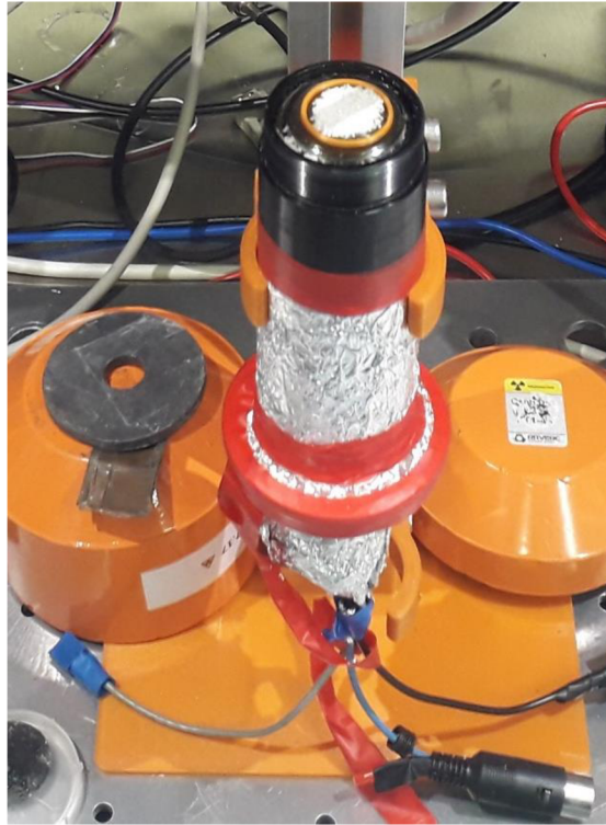
Obrázek 27: Fotografie z přípravy práškového scintilátoru CEBR.
