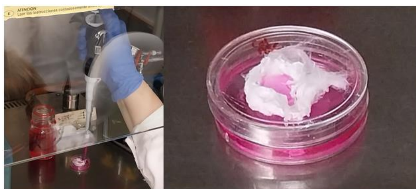
Obr. 19: Zalití vzorku 2 ml média (vlevo), výsledný vláknenný vzorek s hydrogelem zalitý médiem (vpravo)
