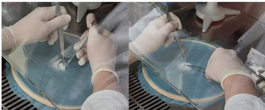
Obr. 18: Odstrhávání nanovláknenného vzorku ze spunbondu
