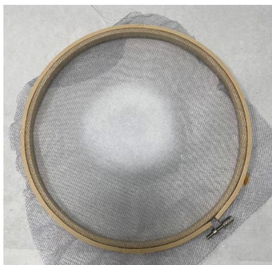
Obr. 26: Kolektor pro nanovlákněné vrstvy vyrobené metodou SBS a aplikovaná nanovlákněná vrstva z roztoku 8% PCL v DCM
