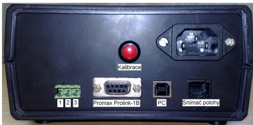
Obr. 5.7: Zadní panel krabičky ovladače.
