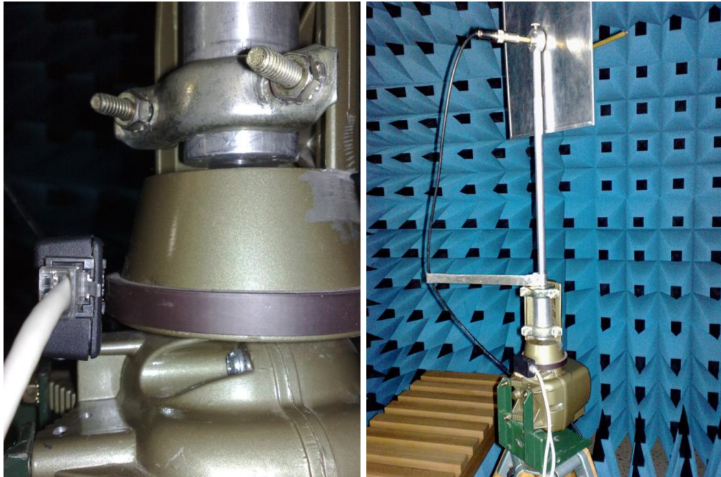
Obr. 3.8: Detail snímače a jeho umístění na anténním rotátoru.
