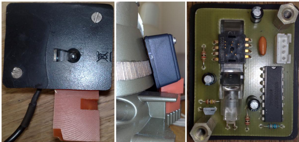
Obr. 3.2: Použitý snímač polohy.
