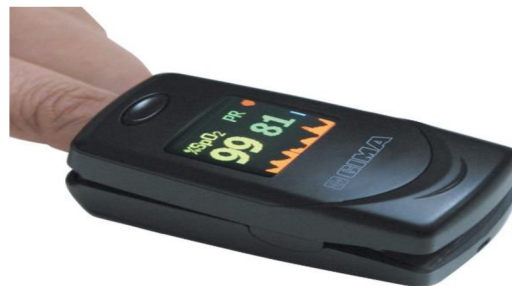
Obrázok 2 Pulzný oxymeter pre meranie na prste, prevzaté z [21]
