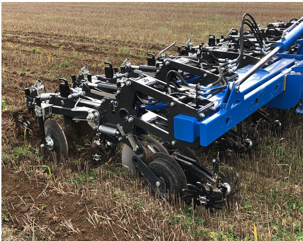
Obr. 4. Stroj na pásové zpracování půdy (www.pal.cz)
