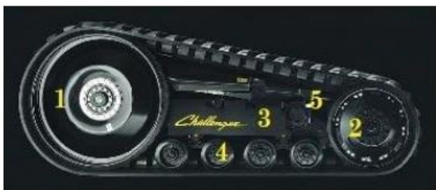
1 - hnací kolo, 2 - napínací kolo, 3 - centrální nosník, 4 - středové vodící kladky, 5 - napínací mechanismus
