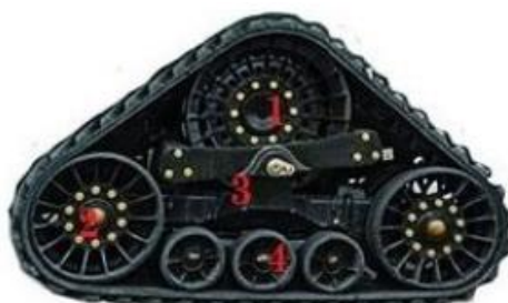
1 - hnací kolo, 2 - napínací kolo, 3 - centrální nosník, 4 - středové vodící kladky, 5 - napínací mechanismus
