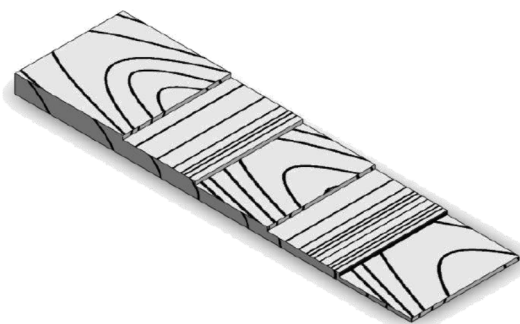
Obr. 8 Orientace dýh v překližce (Minárik 2014)
