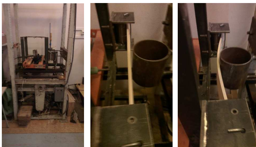
Obr. 30 Cyklovací stroj, vzorek před průhybem, vzorek v průhybu
