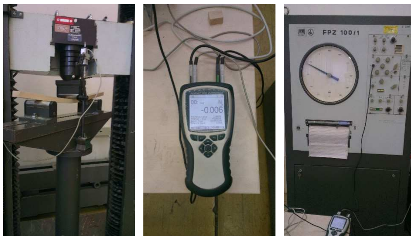
Obr. 27 Průběh ohybové zkoušky, ALMEMO 2690, nastavení trhačího stroje
