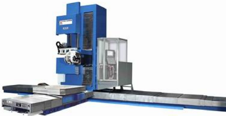
Obr. 3.2 Frézovací centrum s posuvným stojanem FU, včetně umístění přijímače rádiové sondy RMI. [5], [22]
