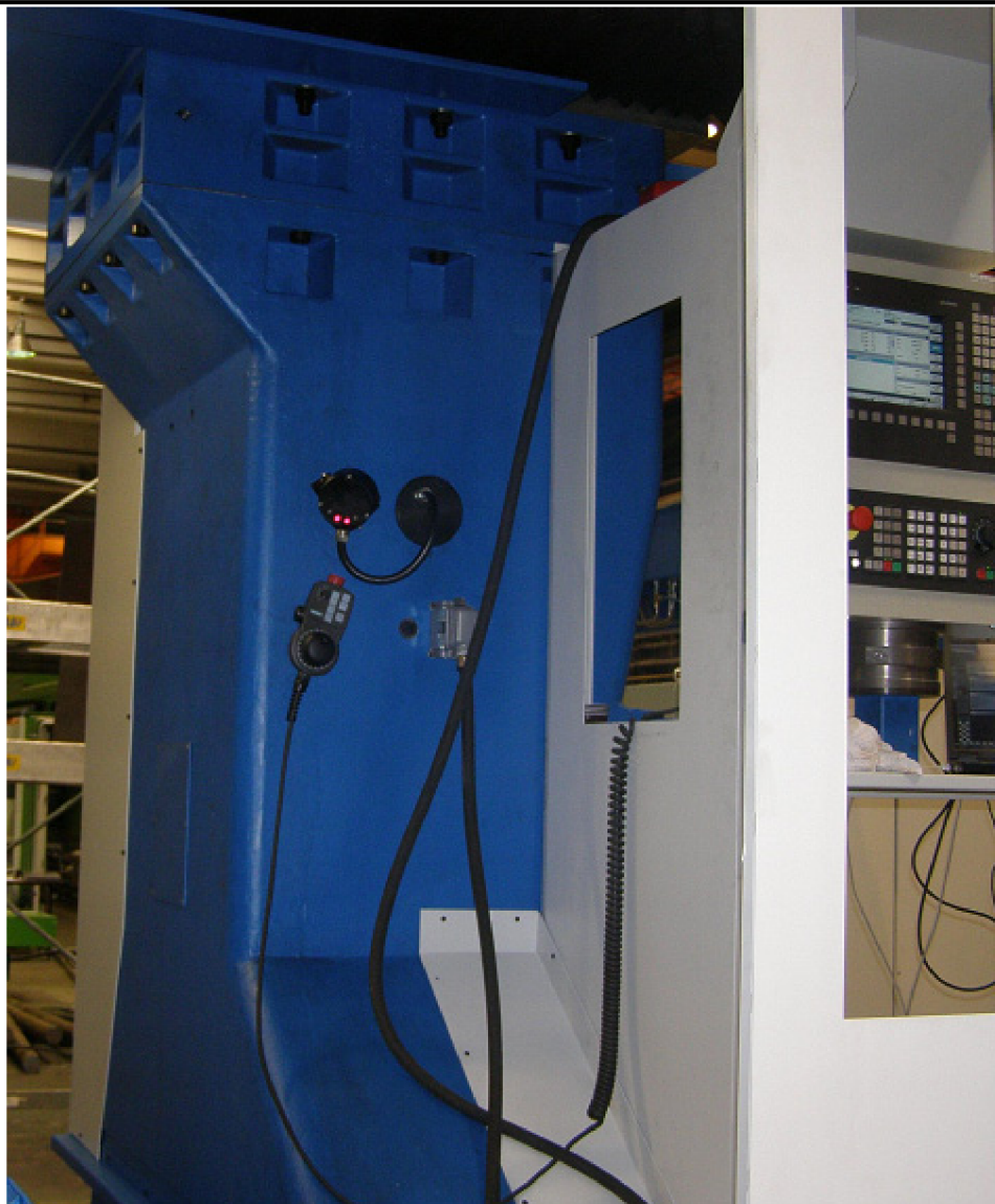
Obr. 4.4 Umístění přijímače RMI obrobkové sondy RMP 60 ve středu jednoho ze sloupů posuvného portálu. [22]
