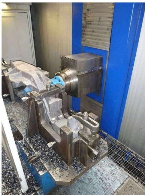
Obr. 4.14 Horizontální obráběcí centrum FOQ 80 s automatickou výměnou nástrojů a otočným stolem. [22]
