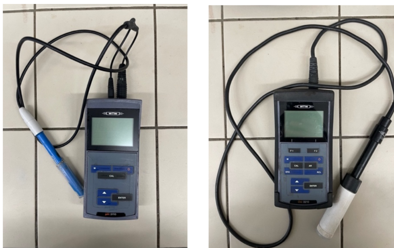
Obrázek 10 vlevo pH metr WTW 340i, obrázek 11 vpravo oxymetr WTW Oxi3210
