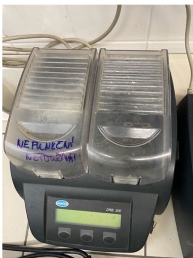
Obrázek 12 vlevo mineralizační box HACH DRB 200, obrázek 13 spektrofotometr HACH DR 3900
