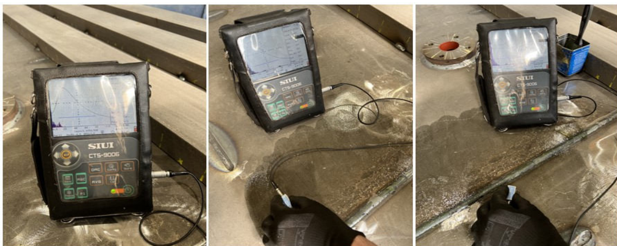
Obr. 42 Zkoušení svaru ultrazvukem
