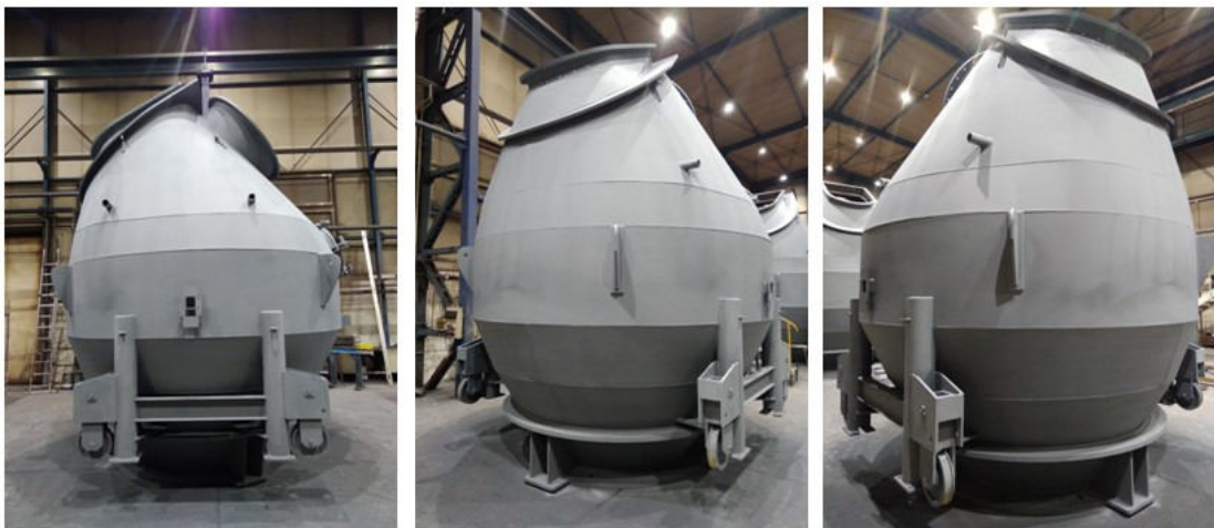
Obr. 31 Zkompletovaný a nalakovaný materiálový zásobník
