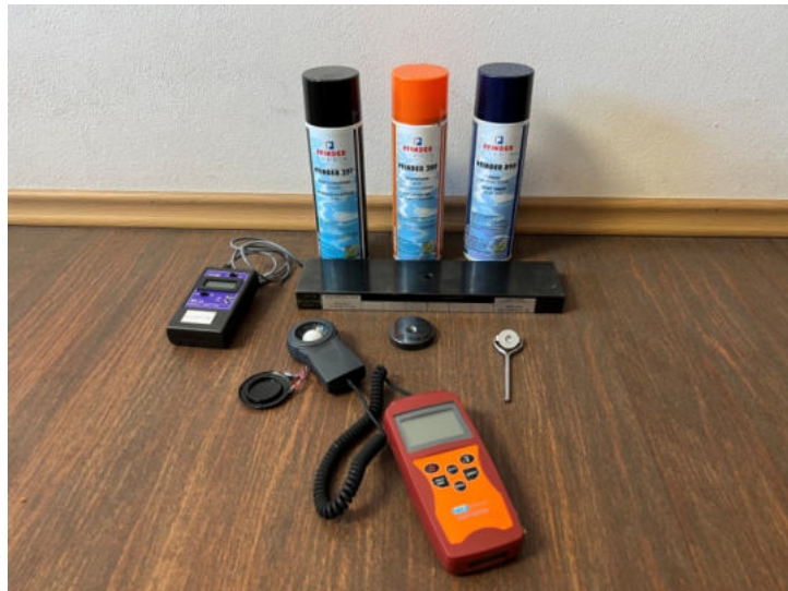
Obr. 39 Použité vybavení na magnetickou práškovou zkoušku
