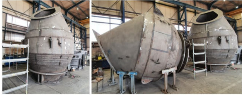
Obr. 27 Přivaření hrdla pro násypku
