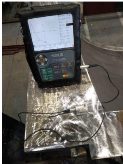
Obr. 19 Vyhodnocení ultrazvukové zkoušky NDT
