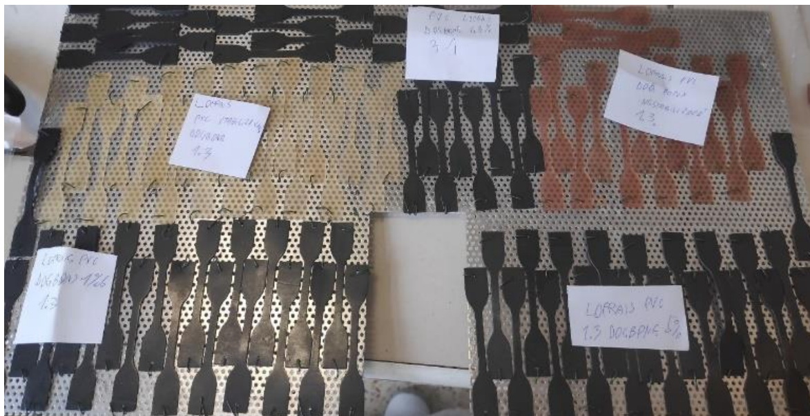
Obr. 30: Vzorky PVC před osvitom v přístroji Q-sun.
