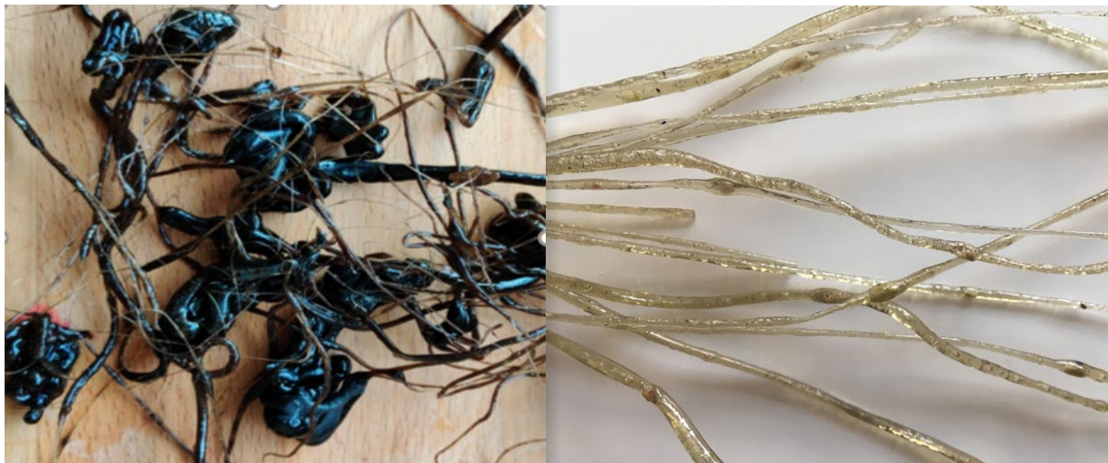
Obr.58 Čirý PET, nepraný (vlevo), praný (vpravo)
