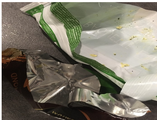
Obr.52 Jednodruhová (nahore) vs. kompozitní (dole) obalová fólie
