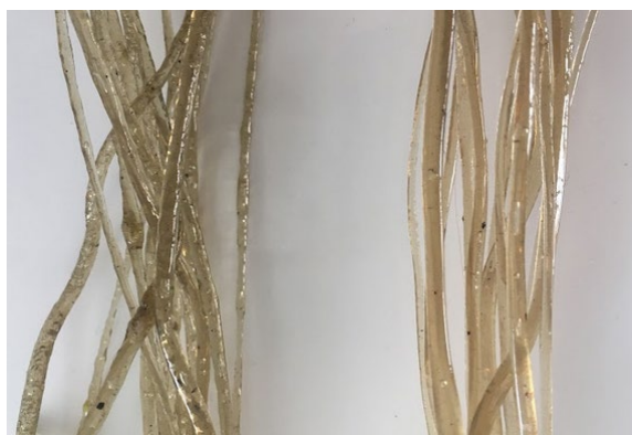
Obr.68 Porovnání struny vzniklé první (vlevo) a druhou (vpravo) extruzí – čirý PET
