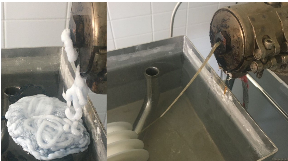
Obr.63 Struna – nesušený (vlevo) a sušený (vpravo) vstupní materiál z PET
