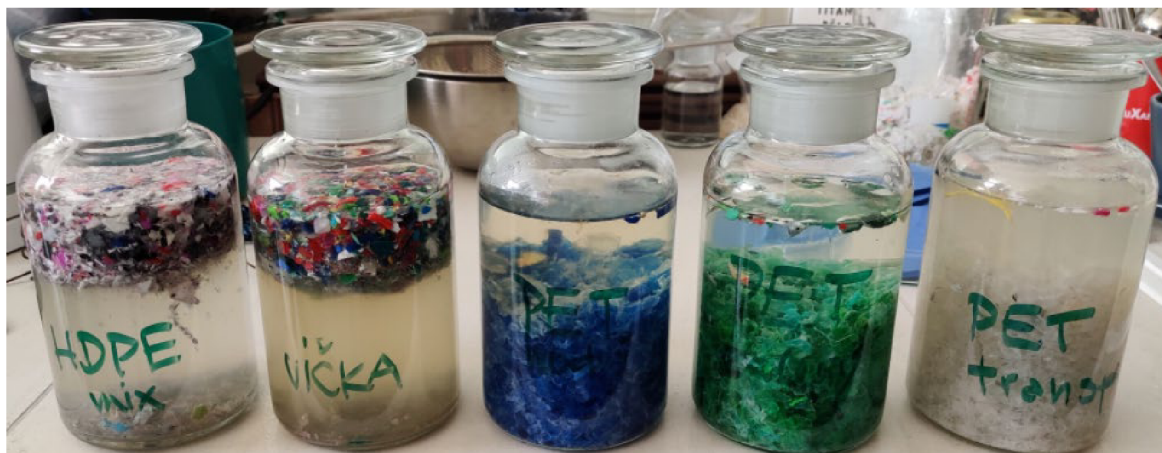
Obr.55 Analyzované plasty ponořené do vody
