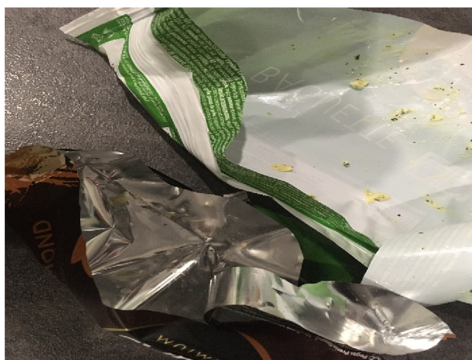
Obr.52 Jednodruhová (nahore) vs. kompozitní (dole) obalová fólie
