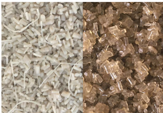
Obr.69 Porovnání regranulátu po první (vlevo) a druhé (vpravo) extruzi – čirý PET
