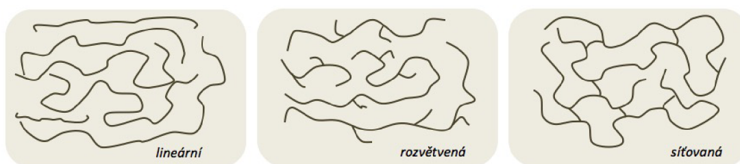
Obr.14 Tvar makromolekul polymeru [12o]
