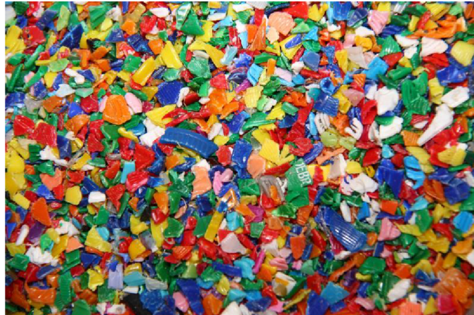
Obr.19 Recyklát – flaky [17o]
