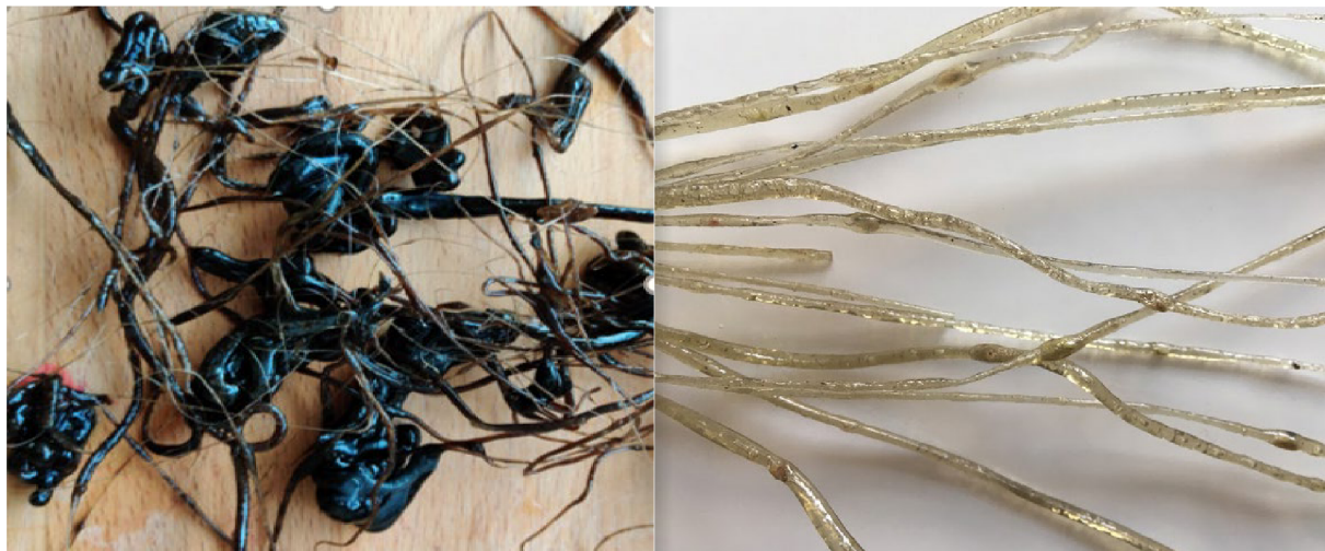
Obr.58 Čirý PET, nepraný (vlevo), praný (vpravo)
