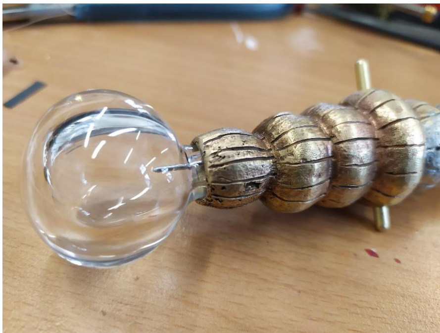
Obr. 36 - Vložená baňka a tyčinka před galvanizací
