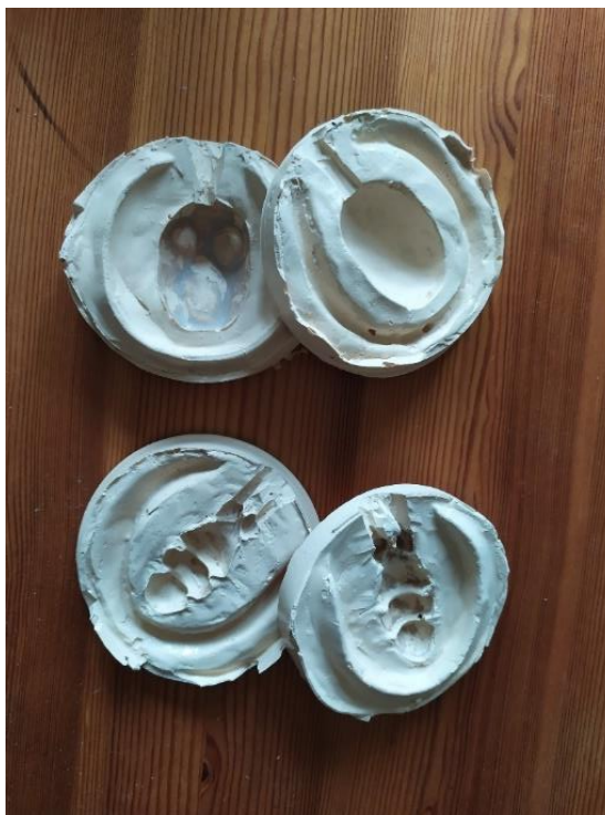
Obr. 64 - Lukoprenové formy na odlitky z epoxidové pryskyřice
