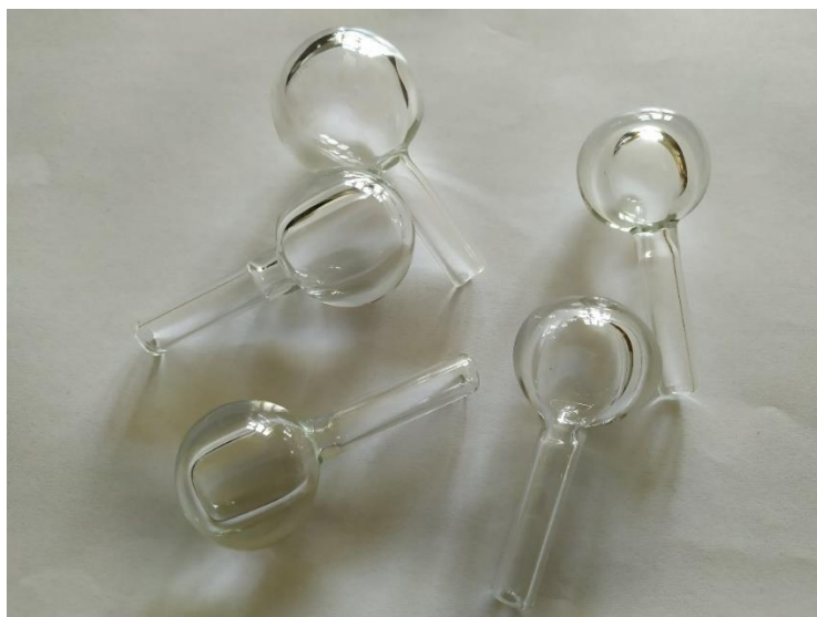
Obr. 34 - Boritokřemičité, tlustostěnné, skleněné baňky
