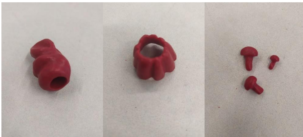
Obr. 72-74 - Voskové modely komponentů k hůlce
