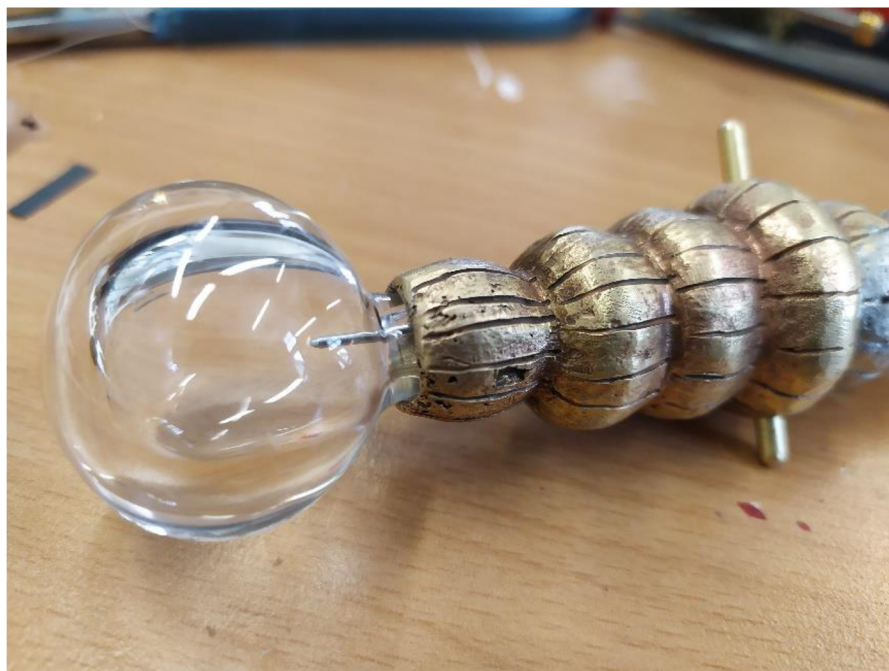
Obr. 36 - Vložená baňka a tyčinka před galvanizací
