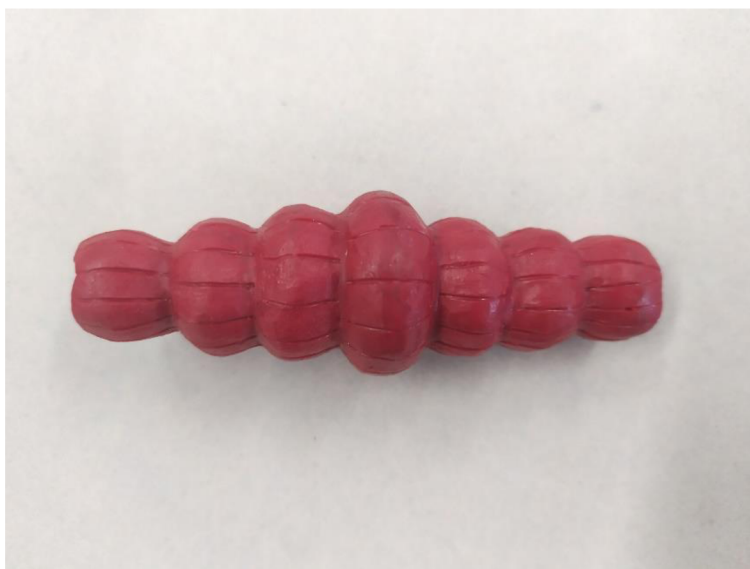
Obr. 35 - Spojovací díl inspirovaný tělem světlušek
