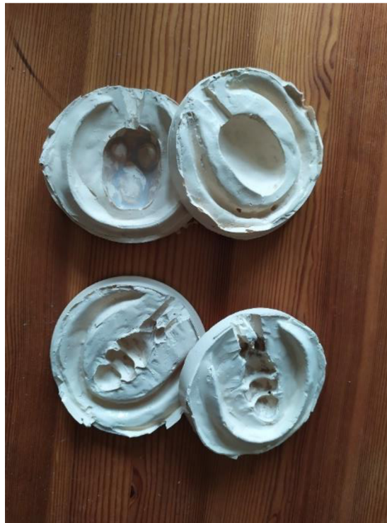
Obr. 64 - Lukoprenové formy na odlitky z epoxidové pryskyřice
