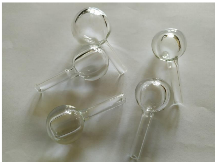
Obr. 34 - Boritokřemičité, tlustostěnné, skleněné baňky
