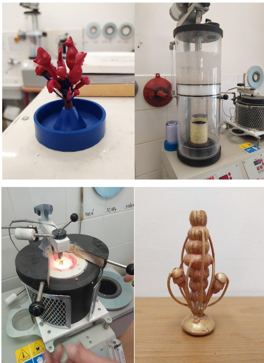
Obr. 26-29 - Proces odlévání kovů – stromeček, lití sádry, odlévání, finální odlitek
