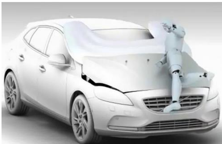
Obrázek č. 6 Systém aktivní kapoty s airbagy pro chodce
