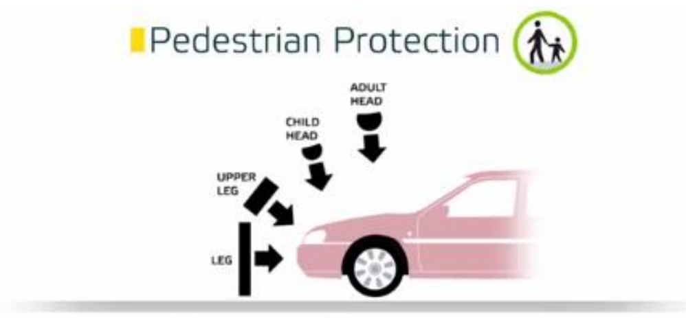
Obrázek č. 1 Nárazový test automobilu do impaktoru
