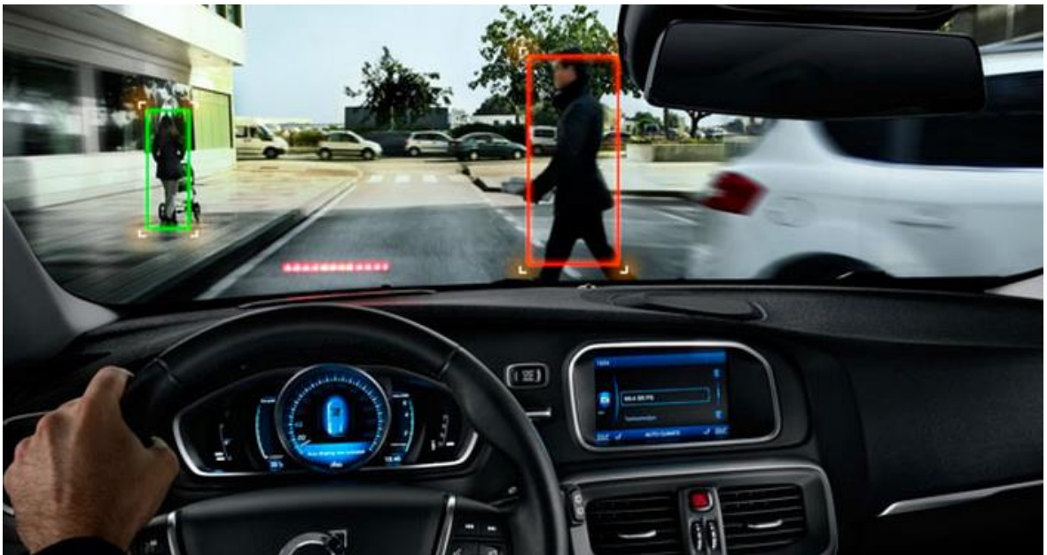
Obrázek č. 2 Samostatný systém nouzového brždění s detekcí chodců
