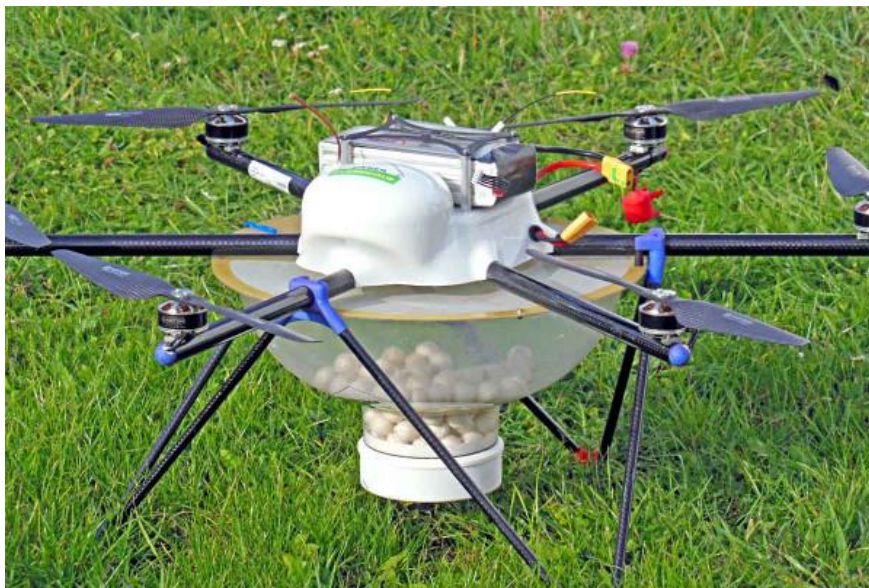
Obrázek 3 Dron s výbavou pro aplikaci biologických prostředků na ochranu rostlin
