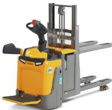
Obr. 14, Vysokozdvižný vozík Jungheinrich ERD 220, zdroj: www.jungheinrich.cz
