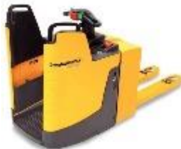
Obr. 13, Nízkozdvižný vozík Jungheinrich ERE 225, zdroj: www.jungheinrich.cz
