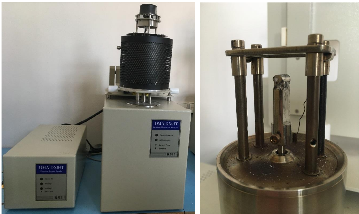
Obr. 3.11 Přístroj DMA DX04T (vlevo) s trojbodovým ohybem (vpravo)
