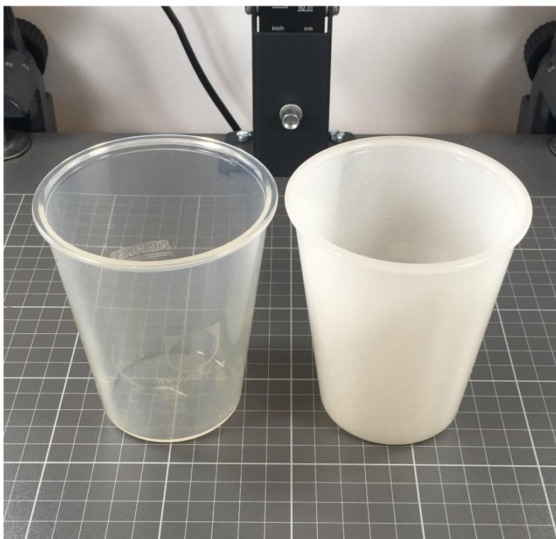
Obr. 4.55 Vyrobené kelímky z izotaktické PLLA (vlevo) a symetrické směsi PLLA a PDLA s 1 % OA (vpravo)
