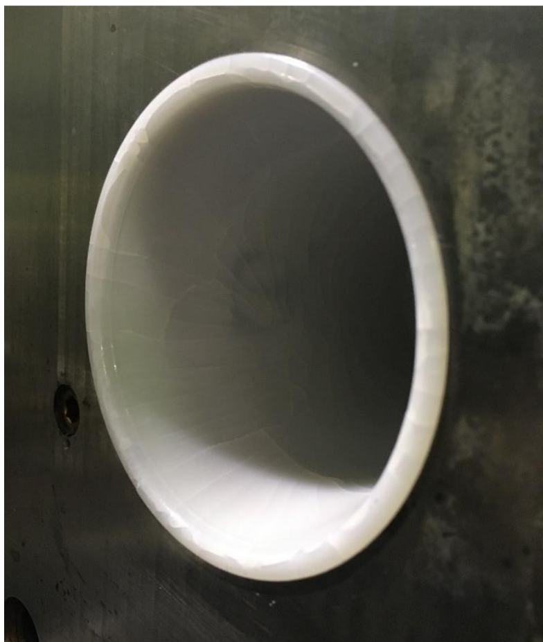
Obr. 4.54 Poškozený kelímek, který je zafixován v tvárnici vstříkované formy
