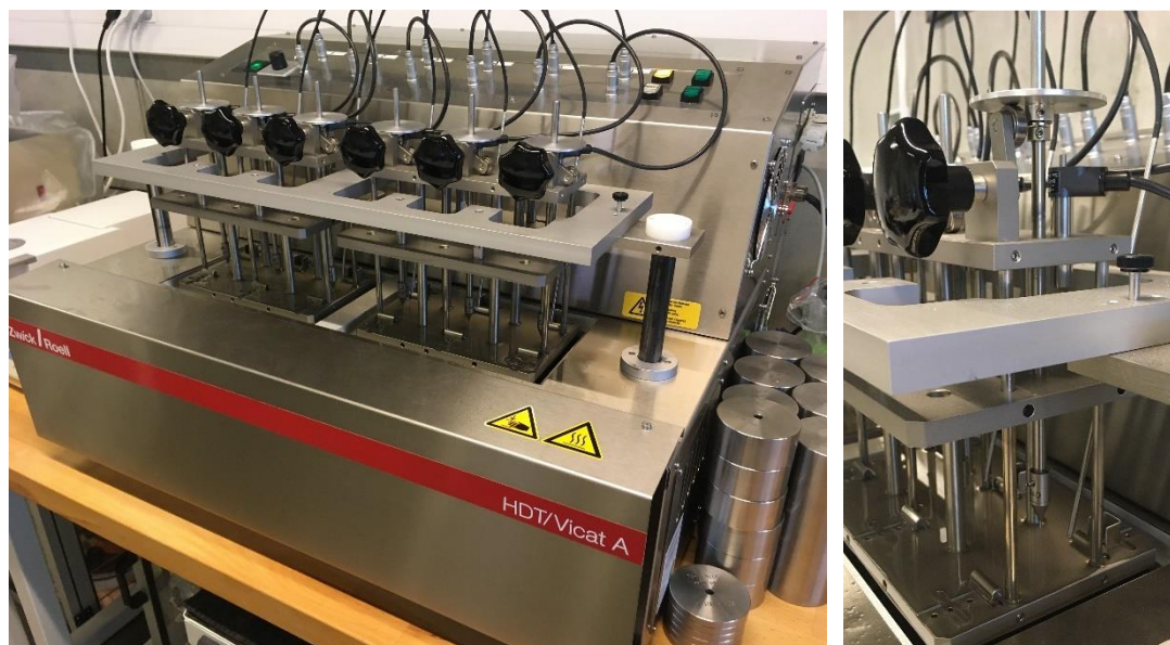
Obr. 3.10 Přístroj pro měření HDT/Vicat od firmy Zwick/Roell (vlevo) a sestava pro měření Vicat (vpravo)
