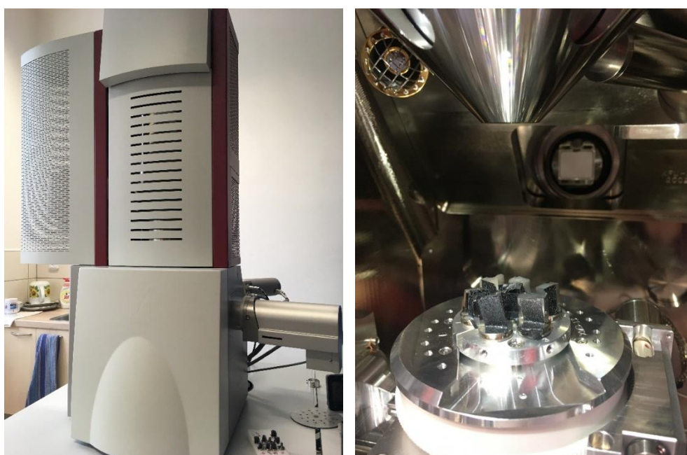
Obr. 3.7 Rastrovací elektronový mikroskop TESCAM MIRA 3 (vlevo) a komora elektronového mikroskopu (vpravo)
