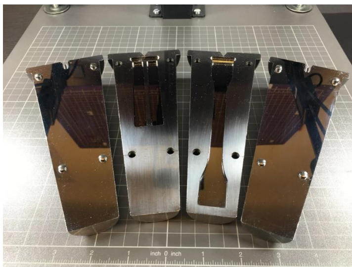
Obr. 3.6 Formy pro vstřikování zkušebních těles typu (80x10x4) mm (vlevo) a 1B (vpravo) pro vstřikovací přístroj Xplore IM 12
