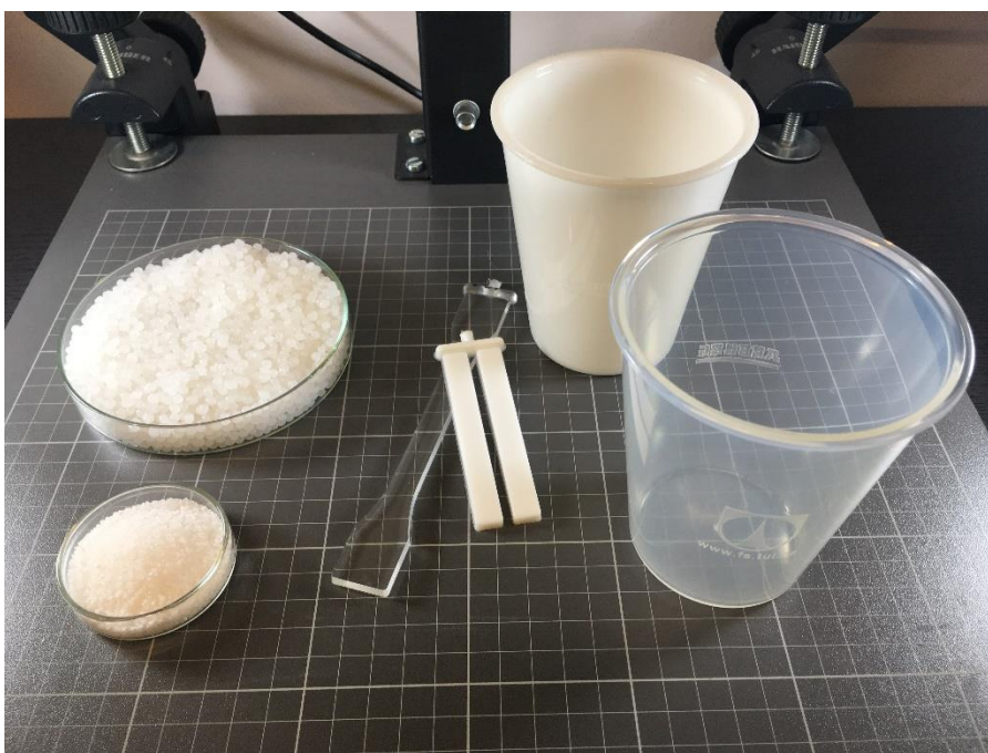
Obr. 3.1 Chronologický postup výroby od granulátu a nukleačního činidla, až po zkušební vzorky a vyhotovené výrobky
