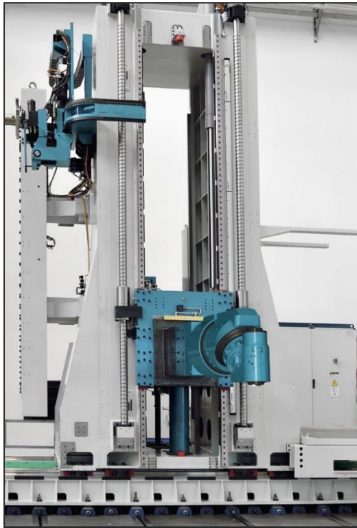
Obr. 2.9 Výsuvný vřeteník „O“ stojan (Pama SpeedMill) [13]
