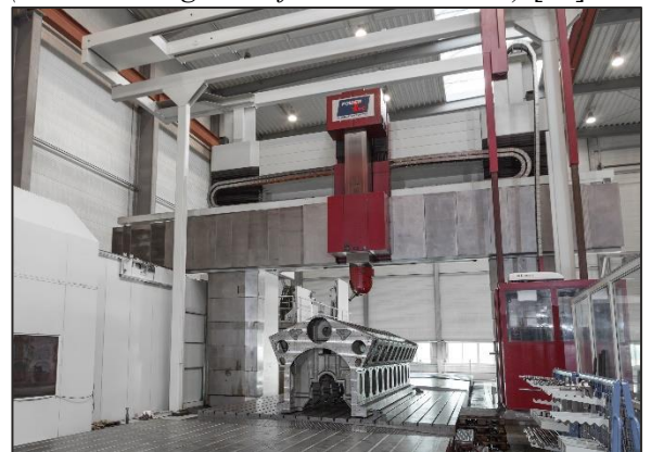
Obr. 2.16 Posuvným stůl s pohyblivým příčником (Waldrich Coburg Powertec) [19]
