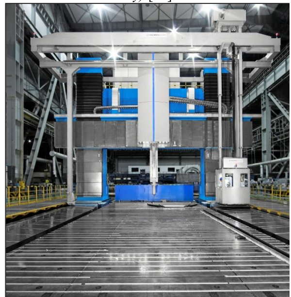
Obr. 2.14 Spodní gántry s pohyblivým příčником (Waldrich Siegen ProfiMill 8500-120/G) [17]
