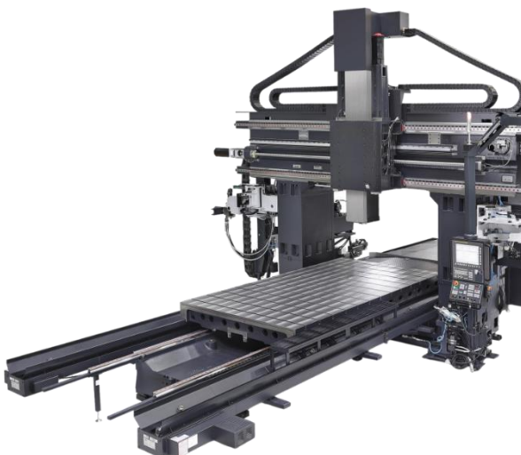
Obr. 2.15 Posuvným stůl s pevným příčником (Doosan dbm 2030) [18]
