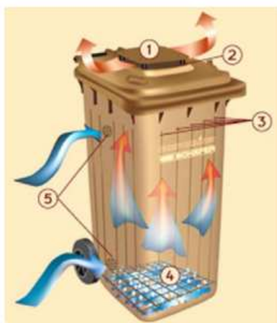
Obrázok 5: Kompostejner (1- veko; 2- vetracie otvory; 3- vnútorné zvislé rebrá; 4- rošt na dne; 5- vetracie otvory)
