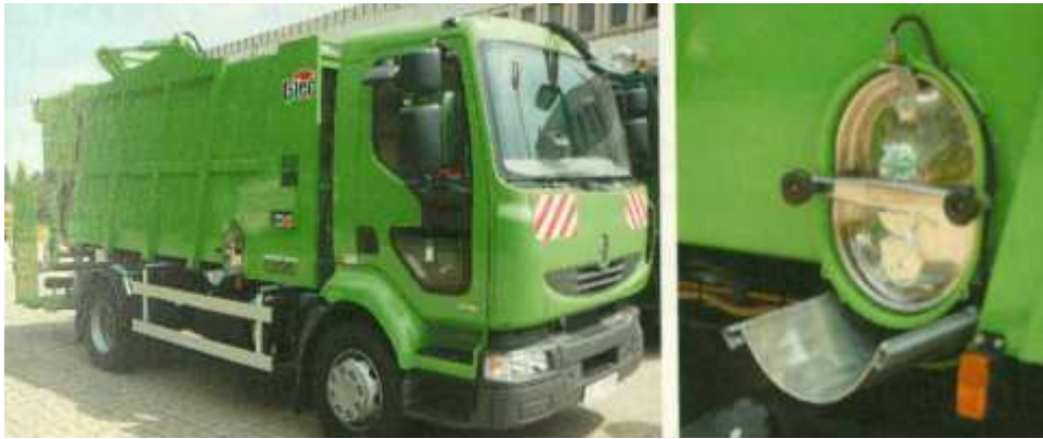
Obrázok 8: Zvozový automobil so zariadeným pre záchyt vody
