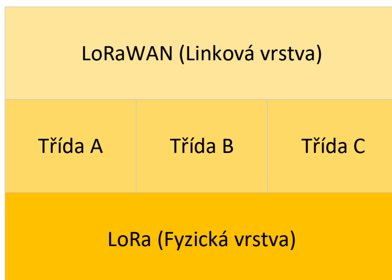
Obr. 2.2: Architektura protokolu LoRaWAN [11].
