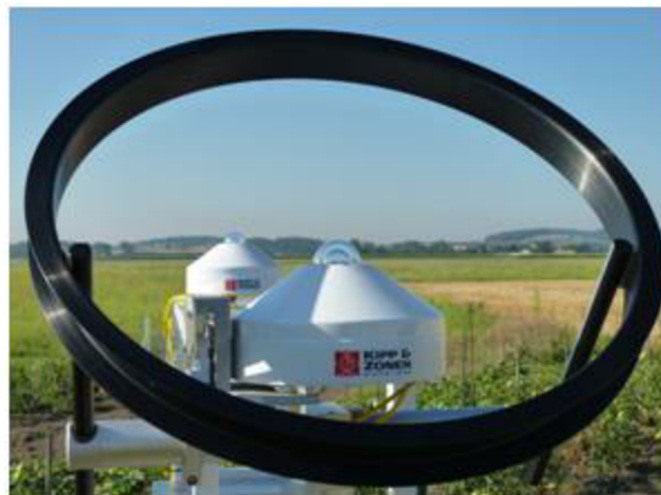
Obr. 14 Pyranometr se stínícím prstencem [22]
