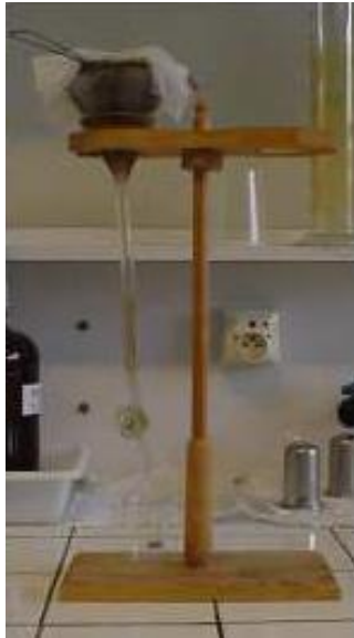
Obr. č. 8: Baermannův aparát (převzato z: http://www2.vetagro-sup.fr/etu/copro/sommaire/techniques/photos/baermann.jpg )
