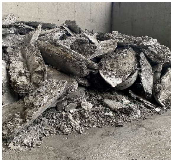
Obrázek 7 Stěry z licích pánvi [vlastní zdroj]
