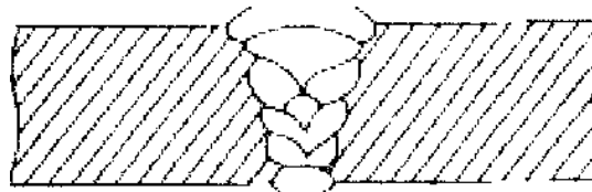
Рис. 3. Многослойное сечение стыкового шва
