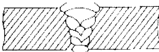
Obr. 4 tupý svar zhotovený svařováním střídavým krokem
