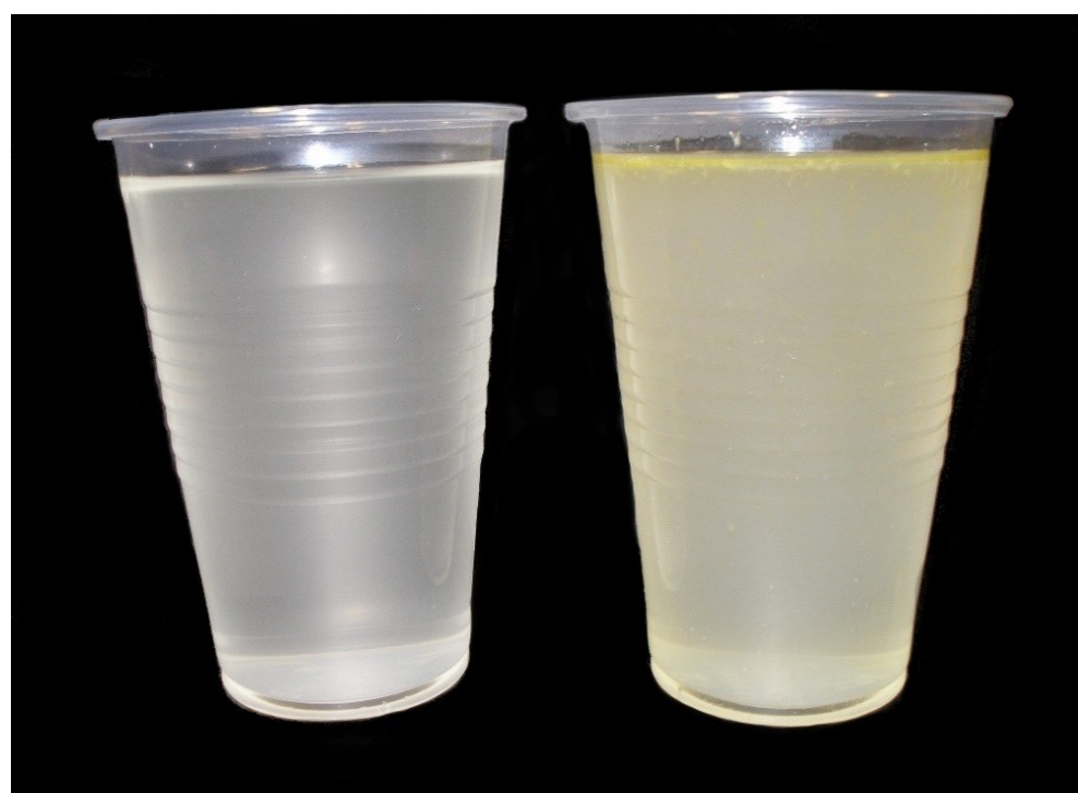
Obr. 29 – Fotografie procesní kapaliny Grindex – vlevo bez přidání hydraulického oleje, vpravo s největším obsahem hydraulického oleje (39ml/l) – fotografie z boku
