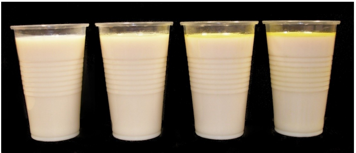
Obr. 25 – Procesní kapaliny s přidaným hydraulickým olejem v různých koncentracích od PK bez přidání hydraulického oleje (vlevo) až po obsah 39ml/l hydraulického oleje v PK (vpravo) – fotografie z boku
