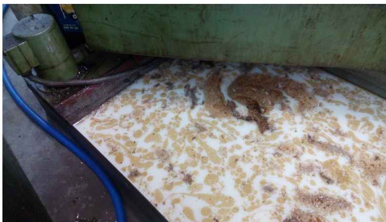
Obr.22 – Externí nádrž s chladicí kapalinou (soustruh SUI40)
