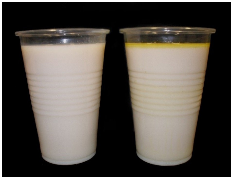
Obr. 27 – Fotografie procesní kapaliny Hocut – vlevo bez přidání hydraulického oleje, vpravo s největším obsahem hydraulického oleje (39ml/l) – fotografie z boku
