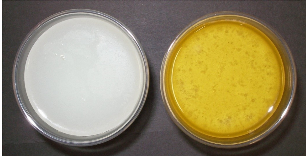
Obr. 32 – Fotografie procesní kapaliny B-Cool – vlevo bez přidání hydraulického oleje, vpravo s největším obsahem hydraulického oleje (39ml/l) – fotografie shora
