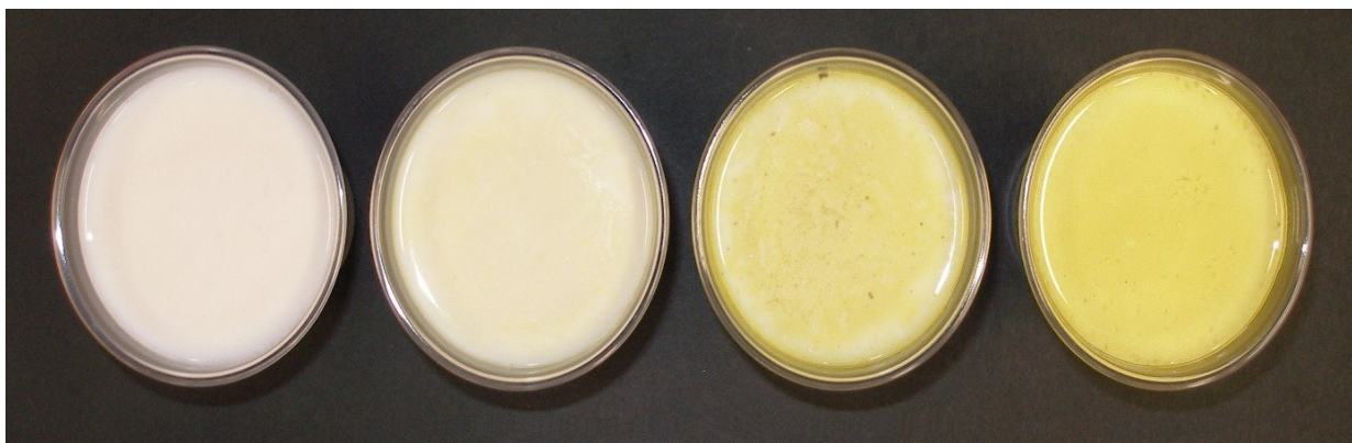
Obr. 26 – Procesní kapaliny s přidaným hydraulickým olejem v různých koncentracích od PK bez přidání hydraulického oleje (vlevo) až po obsah 39ml/l hydraulického oleje v PK (vpravo) – fotografie shora
