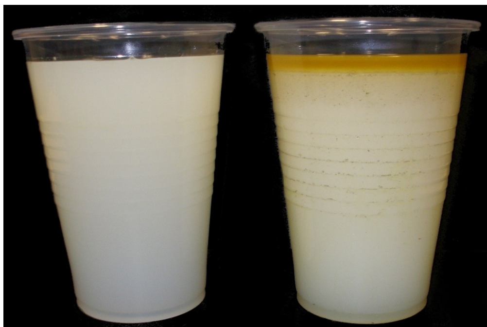
Obr. 31 – Fotografie procesní kapaliny B-Cool – vlevo bez přidání hydraulického oleje, vpravo s největším obsahem hydraulického oleje (39ml/l) – fotografie z boku
