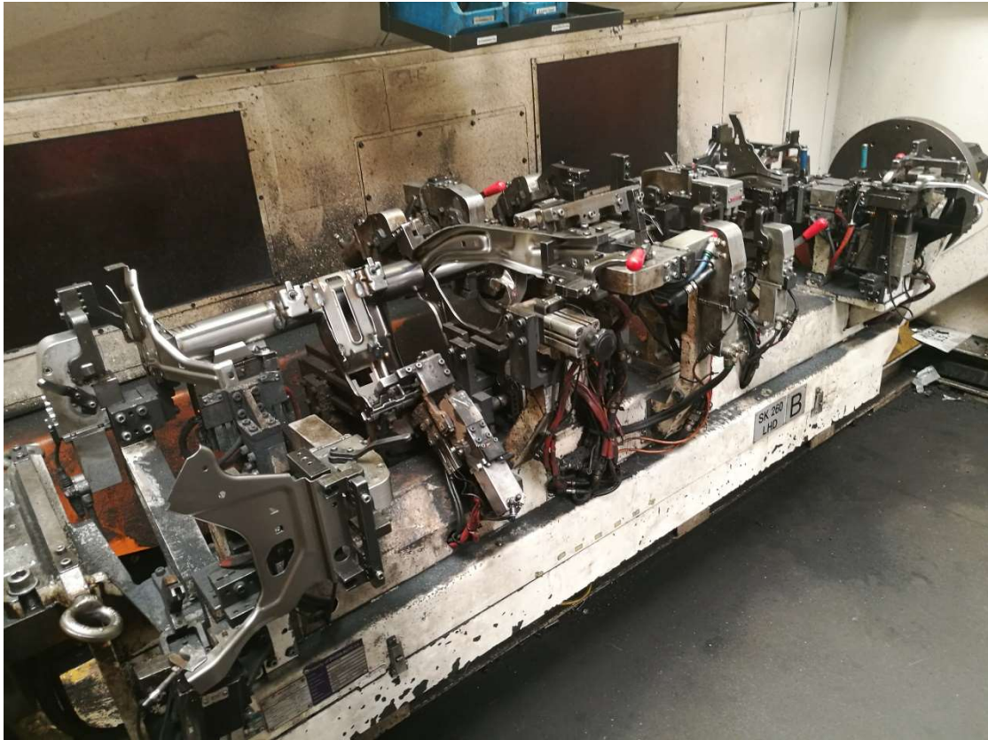
Obr. 28 Upínací přípravek pro svařování centrálního nosiče
