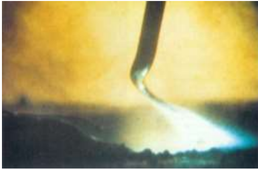
Obr. 9 Rotující přenos kovu [6]
