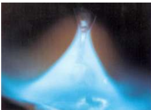
Obr. 8 Bezzkratový přenos kovu [6]
