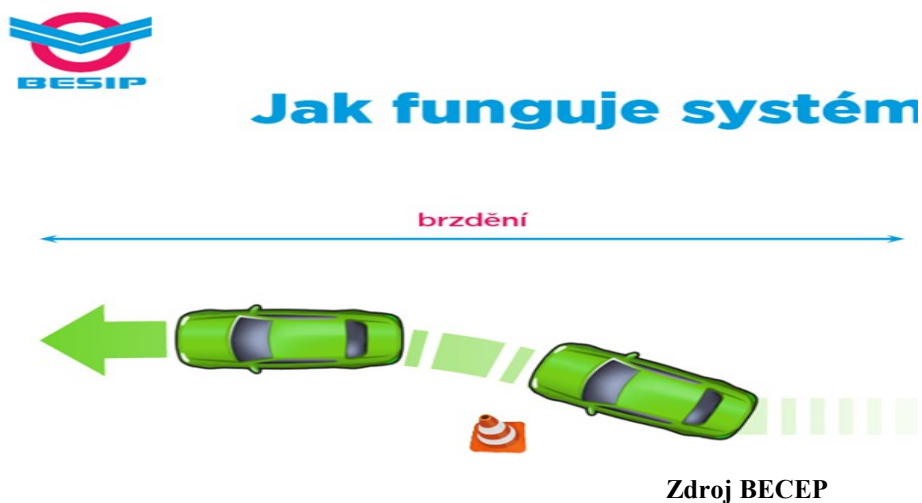
Obrázek 2 Ukázka funkce systému ABS
