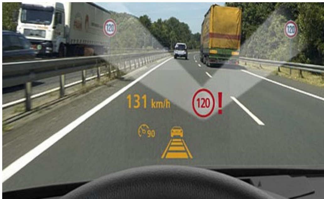
Obrázek 4 Funkce systému čtení dopravních značek
