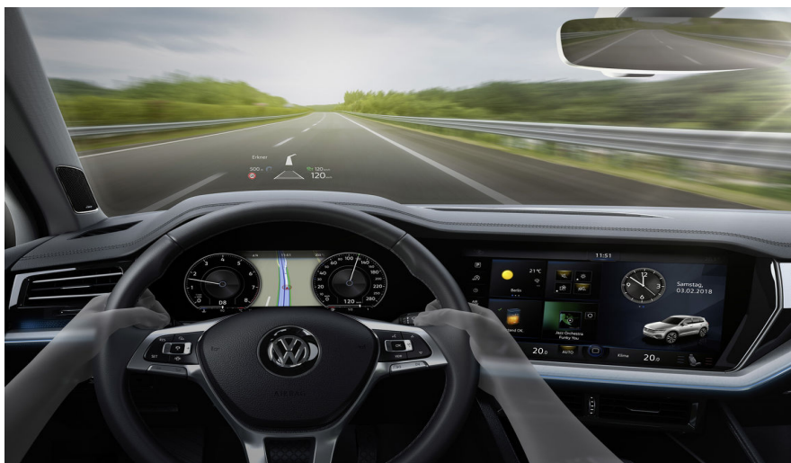
Obrázek 5 Funkce Head-Up Displeje
