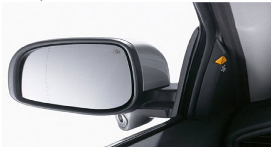
Obrázek 8 Systém hlídání mrtvého úhlu BLIS
