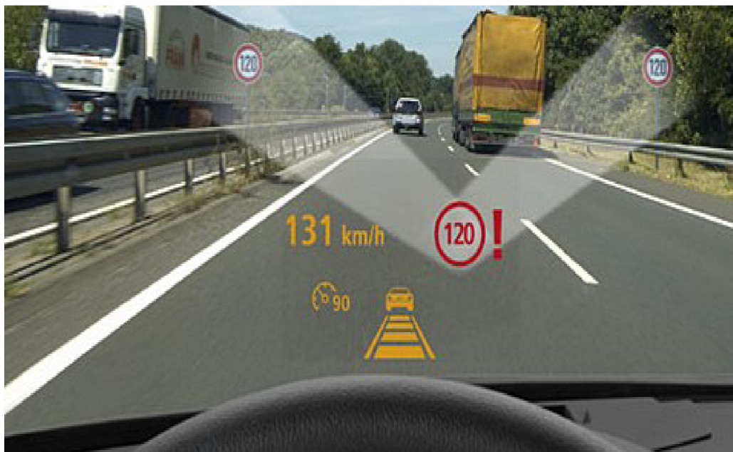
Obrázek 4 Funkce systému čtení dopravních značek
