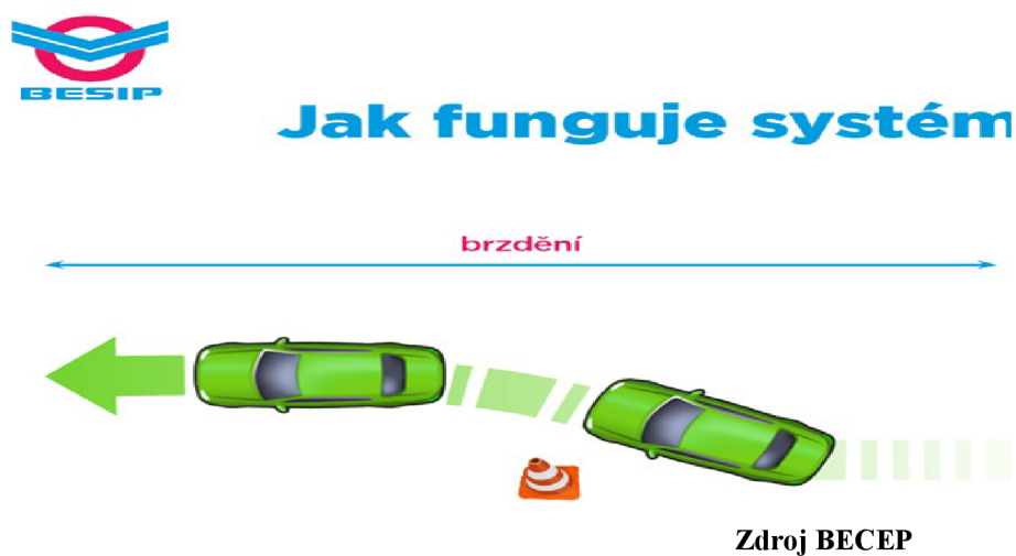
Obrázek 2 Ukázka funkce systému ABS
