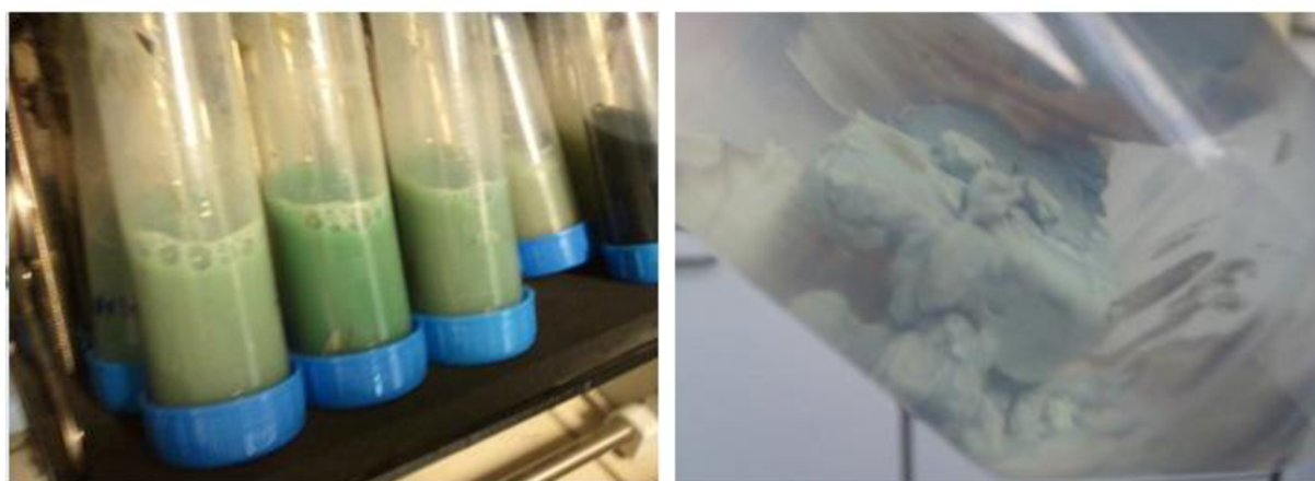
Obr. 11: Vlevo ukázka 5 hodinové adsorpce Z/Mg na míchadle Heidoplh RELAX 2. Vpravo pouhým okem znatelná adsorpce na vzorku Z/Mg 5 minut po zalití vodným roztokem 0,5M \text{CuCl}_2 .
