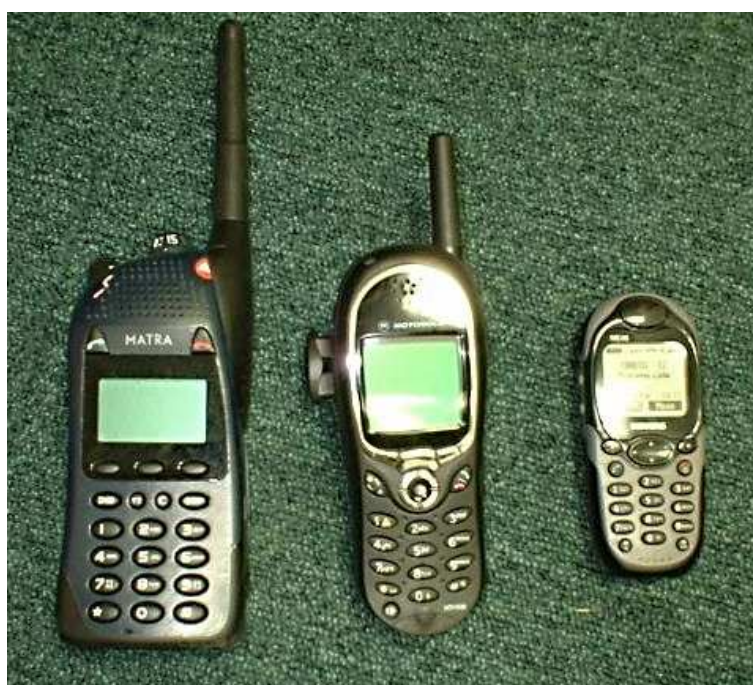
Foto č. 2 – Ruční terminály používaných systémů zleva MATRA, TETRA, GSM
